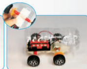
② 在两支轮轴上黏上双面胶带，再把塑料瓶黏在轮轴上。
